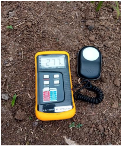
Lux meter untuk mengetahui dan mengukur besarnya intensitas cahaya
