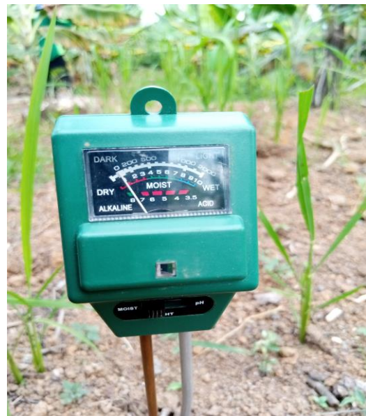
Moisture meter tanah untuk mengetahui kelembaban kadar air tanah
