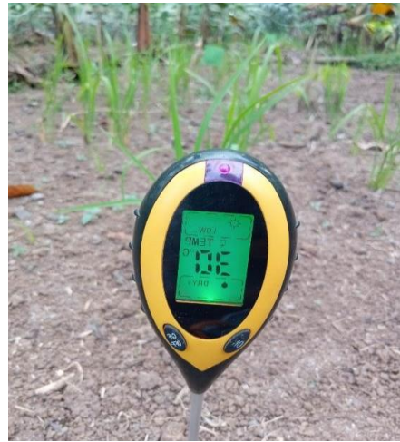
Soil analyzer untuk mengukur Suhu dan ph tanah
