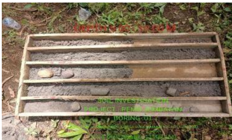
Sample tanah Pasir, gravel dan batu Sumber: Dokumentasi proyek
