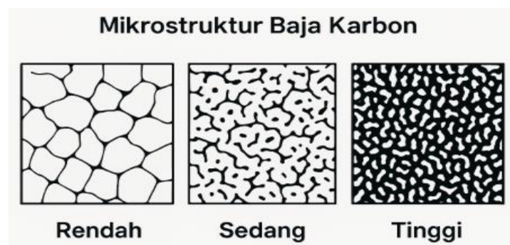
Gambar 2.20 Mikrostruktur Baja Karbon
