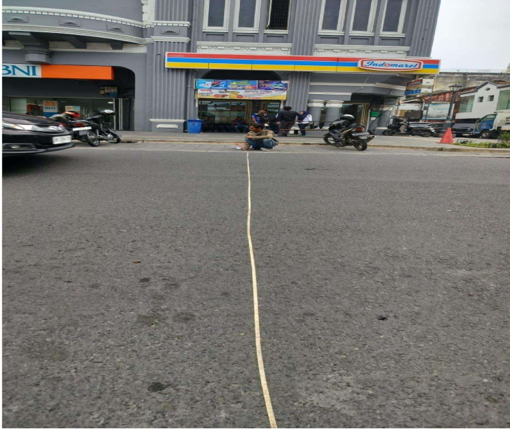
Gambar 1 : Pengukuran lebar jalan
