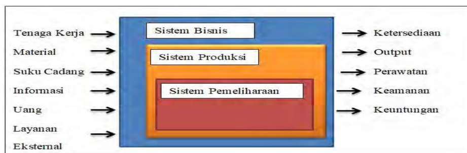
Gambar 2.1 Model Input-Output Proses Pemeliharaan Dalam Sistem Produksi
