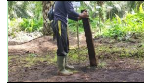
Kotak sampel telah masuk secara keseluruhan
