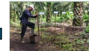
Kotak sampel diketok hingga masuk ke dalam tanah
