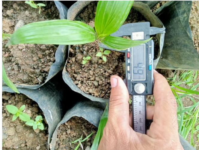
Pengukuran Diameter Batang Menggunakan Digital Caliper
