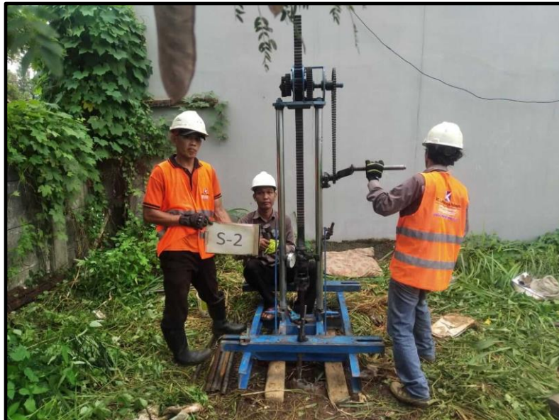
Gambar 2.2 Pengujian Sondir ( Cone Penetration Test ) (Sumber://www.sondir.id)
