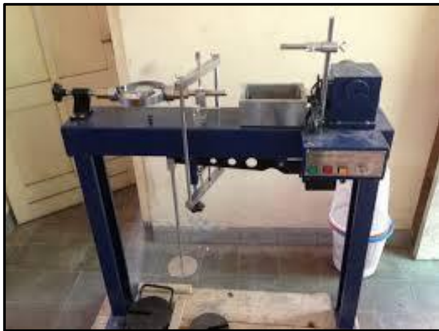
Gambar 2.3 Alat Pengujian Kuat Geser Langsung (Direct Shear Test) (Sumber : Dokumentasi)
