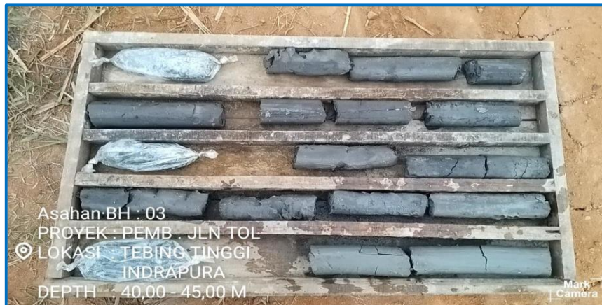
Sample Bor Mesin Titik - 3 (BH-3) Sta. 4 + 150 Kedalaman 40.00 - 45.00 m
