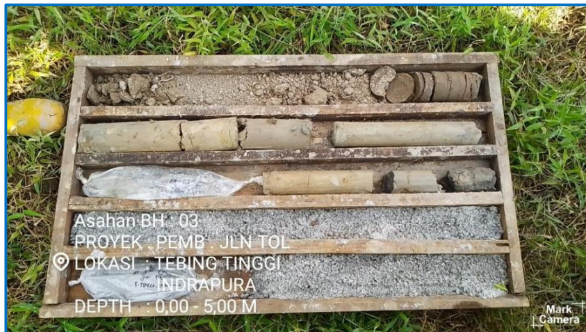
Sample Bor Mesin Titik - 3 (BH-3) Sta. 4 + 150 Kedalaman 0.00 - 5.00 m
