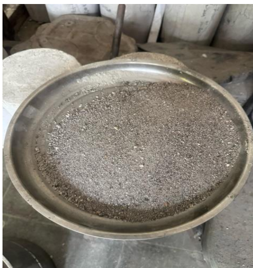
Gambar 2.4 Agregat Halus (Pasir) Sumber : Laboratorium Jalan Raya UISU (2024)
