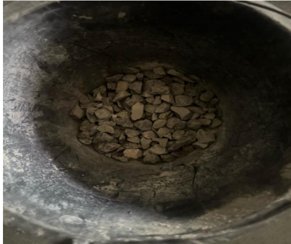
Gambar 2.3 Agregat Kasar (Batu Pecah, Krikil)
