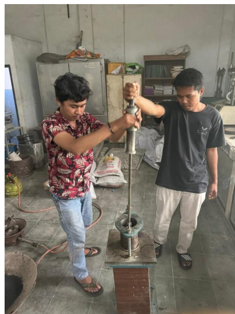
Pemadatan Sampel Benda Uji
