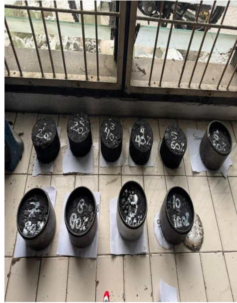
Sampel Benda Uji Aspal Variasi Dalam Cetakan Mold
