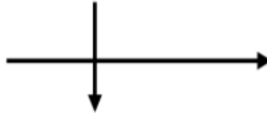
Gambar 2.3: Pergerakan lalu lintas berpotongan pada simpang (PKJI, 2014).
