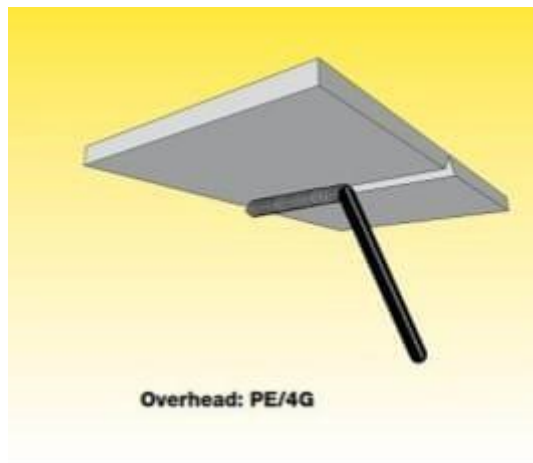
Gambar 2.6 Posisi Pengelasan 4G
