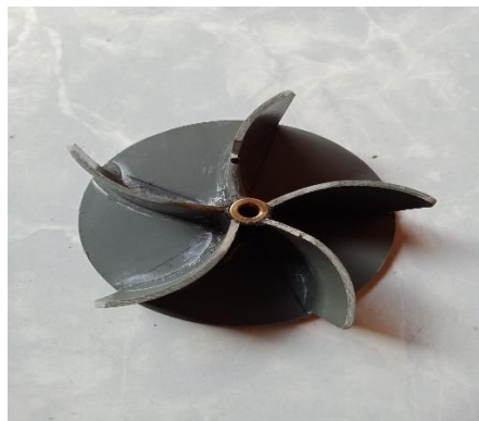
Gambar 2.17. Desain pembuatan Impeller dari pipa pvc
