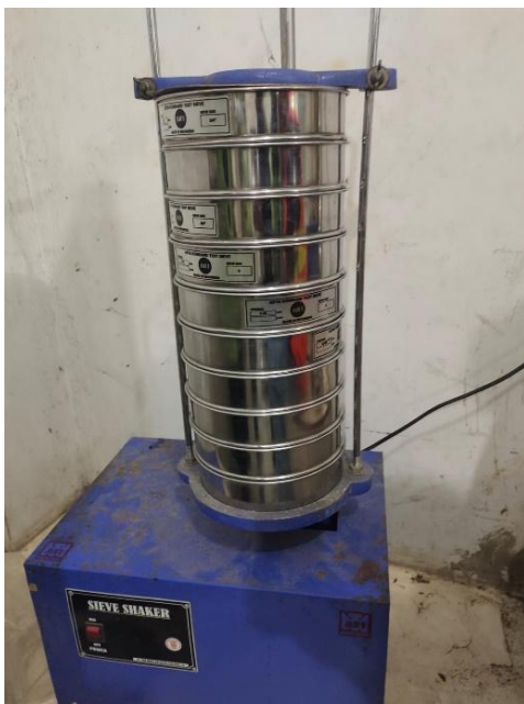
Pengujian Analisa Saringan
