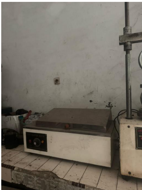
Waterbath untuk memanaskan aspal
