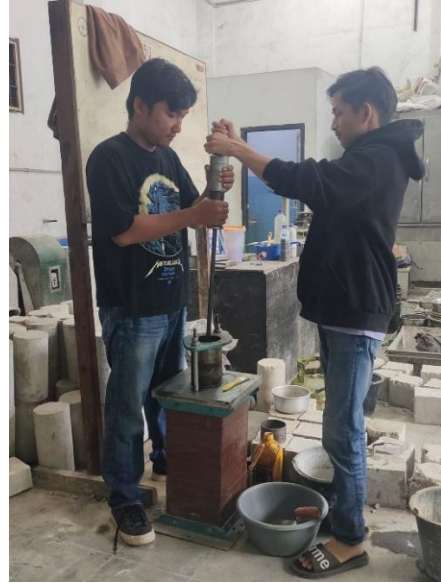
Pemadatan Sampel Benda Uji
