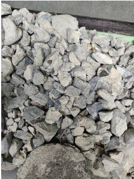
Pecahan Limbah Beton
