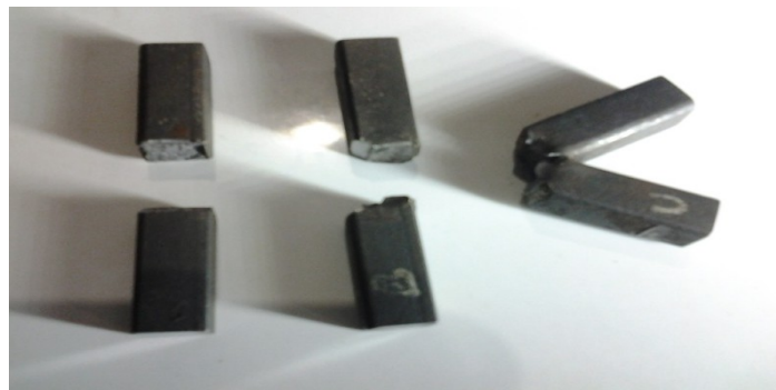
Gambar 2.21 Hasil Patahan dari spesimen bahan yang di uji
