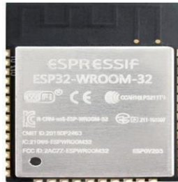
Gambar 2.1 Bentuk Fisik Modul ESP32 Sumber : (Chasanah et al., 2023)
