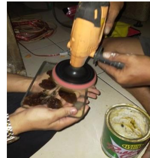
Peroses Penghalusan Acrylic dengan Mesin Rabin dan Kit
