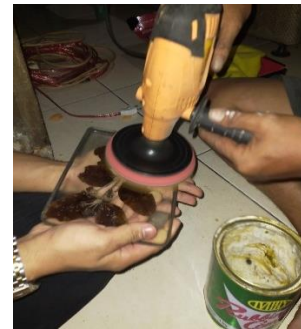
Peroses Penghalusan Acrylic dengan Mesin Rabin dan Kit
