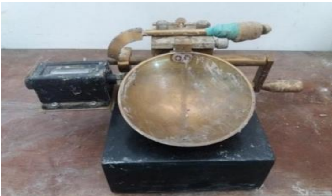
Gambar 2.17 Alat Uji Atterberg
