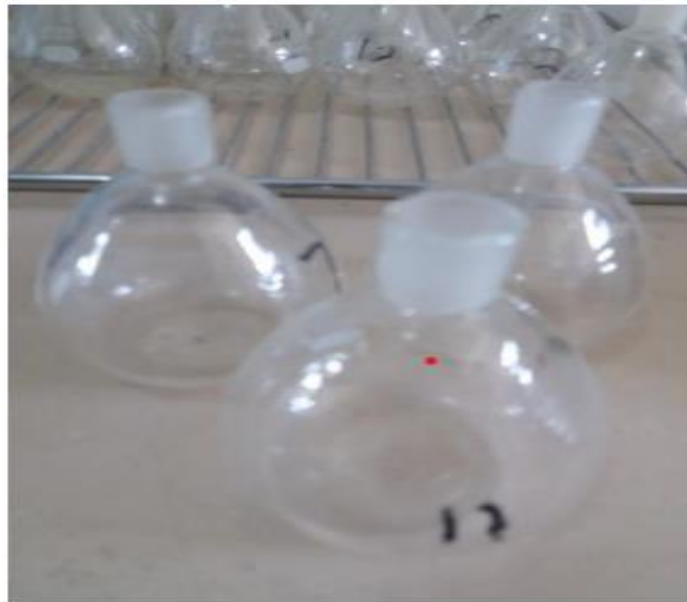
Gambar 2.14 Alat Uji Berat Jenis Tanah
