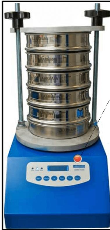
**Gambar 2.5** Ayakan Pengujian (sieve shaker) Sieve Analysis
