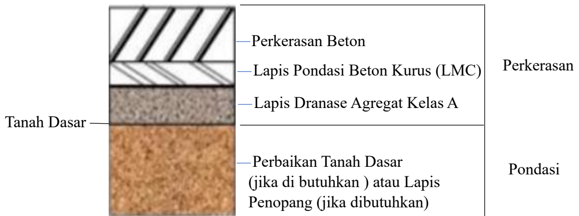
Struktur perkerasan kaku pada permukaan tanah asli ( At Grade )
