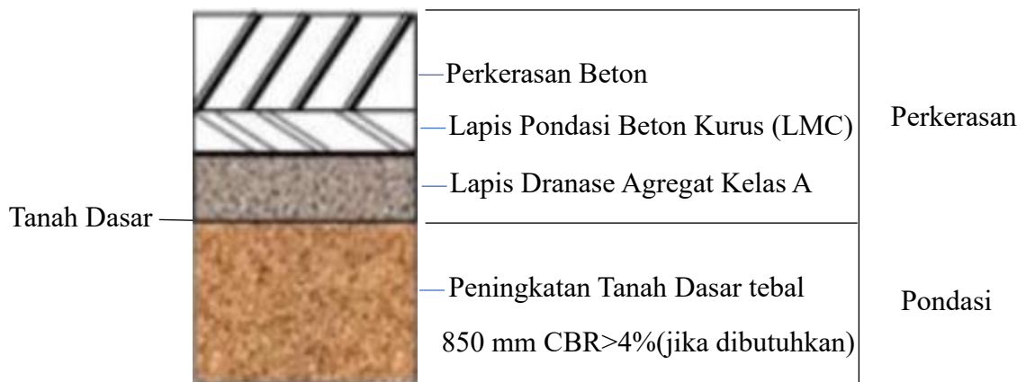
Gambar 2. 5 Lapisan Perkerasan Lentur
