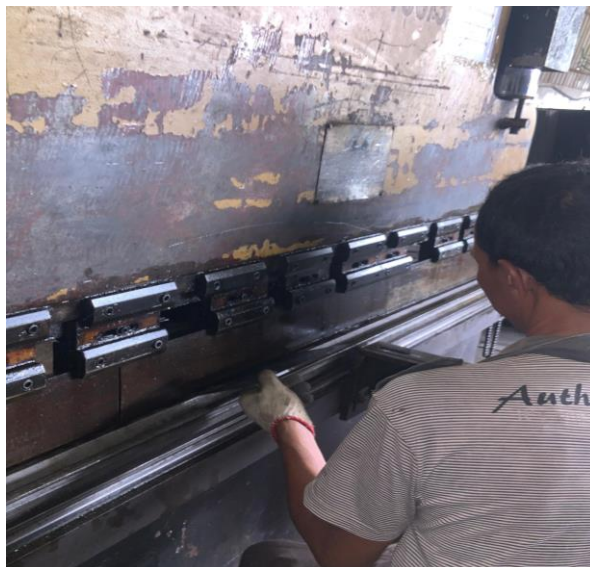
Lampiran 1. Proses Penekukan Pada Mesin Press Brake
