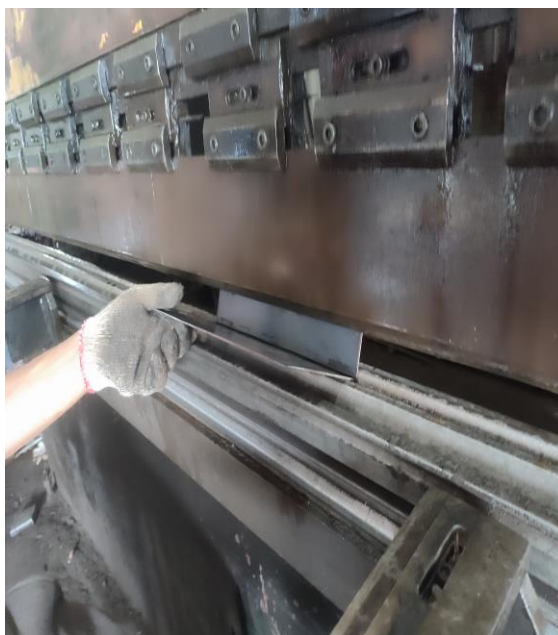
Lampiran 2. Hasil Dari Penekukan Menggunakan Mesin Press Brake
