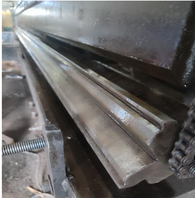
Lampiran 3. Die Yang Di Gunakan Untuk Proses Penekukan
