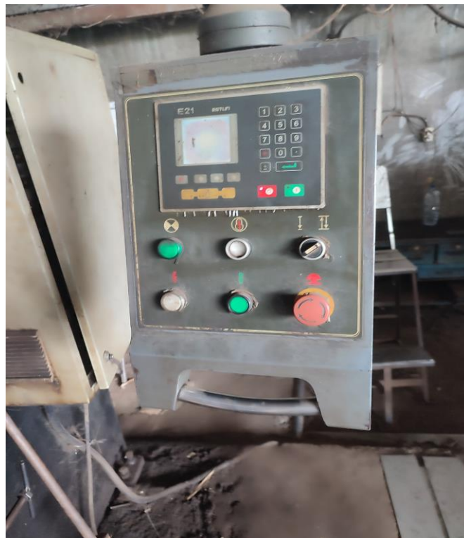
Lampiran 4. Panel Control Pada Mesin Press Brake
