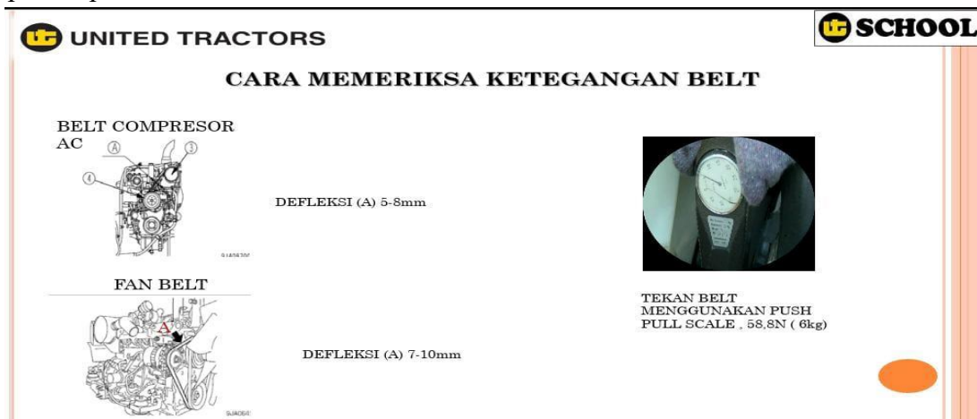
Gambar 2.26 Pengecekan Belt
