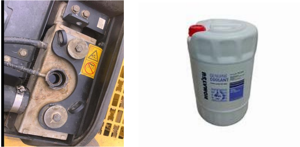
Gambar 2.23 Pengecekan Pada Air Radiator ( coolant )
