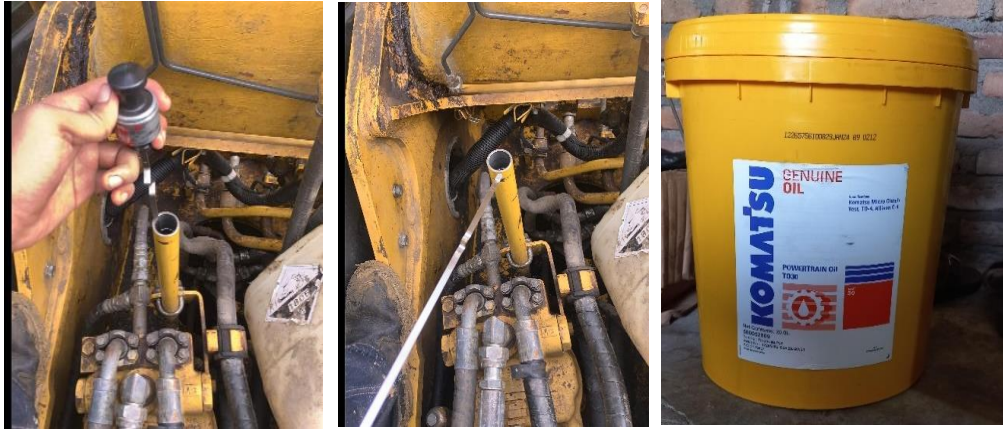
Gambar 2.21 Pengecekan Pada Oli Swing
