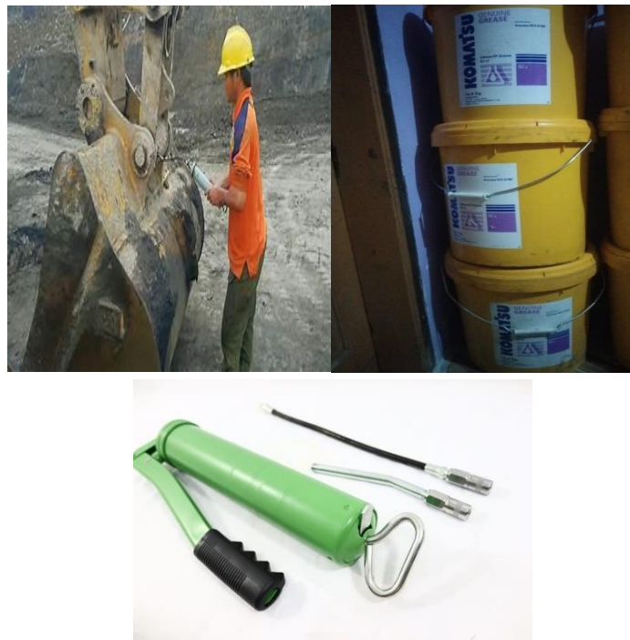
Gambar 2.24 Greasing Pada Alat Berat
