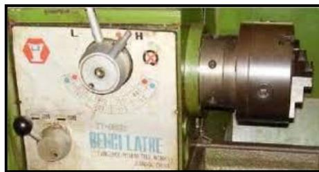
Gambar 2.3 Sumbu Utama (*main spindle*)
