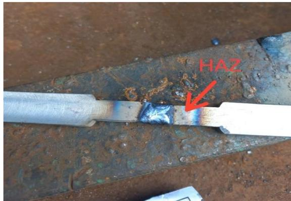
Gambar 2.5 HAZ Efek Pengelasan
