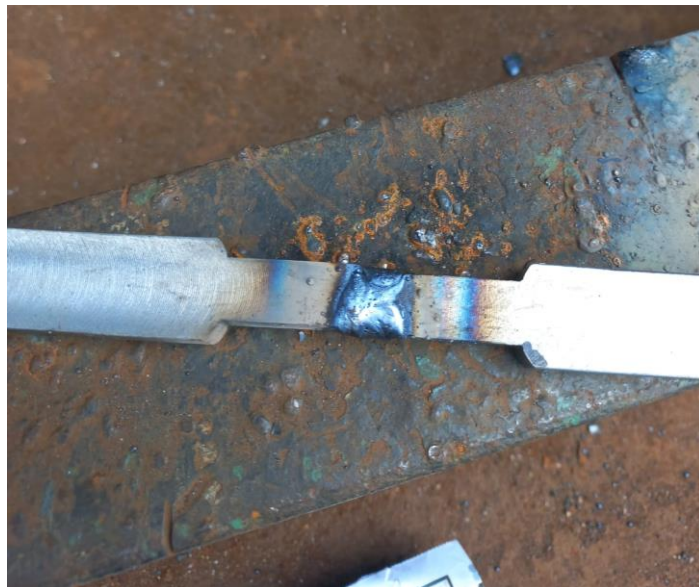
Gambar bahan uji yang telah selesai di lakukan pengelasan dan terlihat daerah HAZ dari pengelasan.
