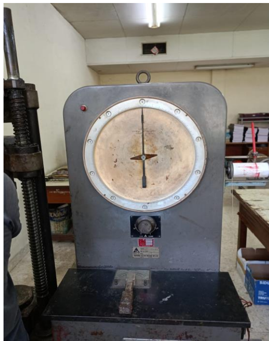
Gambar alat pengujian kekuatan tarik yang hasilnya dapat di lihat secara manual pada jarum penunjuk saat benda di uji sampai putus.
