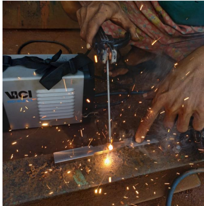
Gambar proses pengelasan sambungan baja dengan las SMAW dengan elektroda E6013 dan variasi arus 90, 100 dan 110 ampere.
