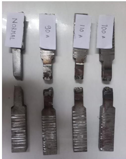
Gambar bahan yang telah putus setelah di lakukan uji kekuatan tarik.
