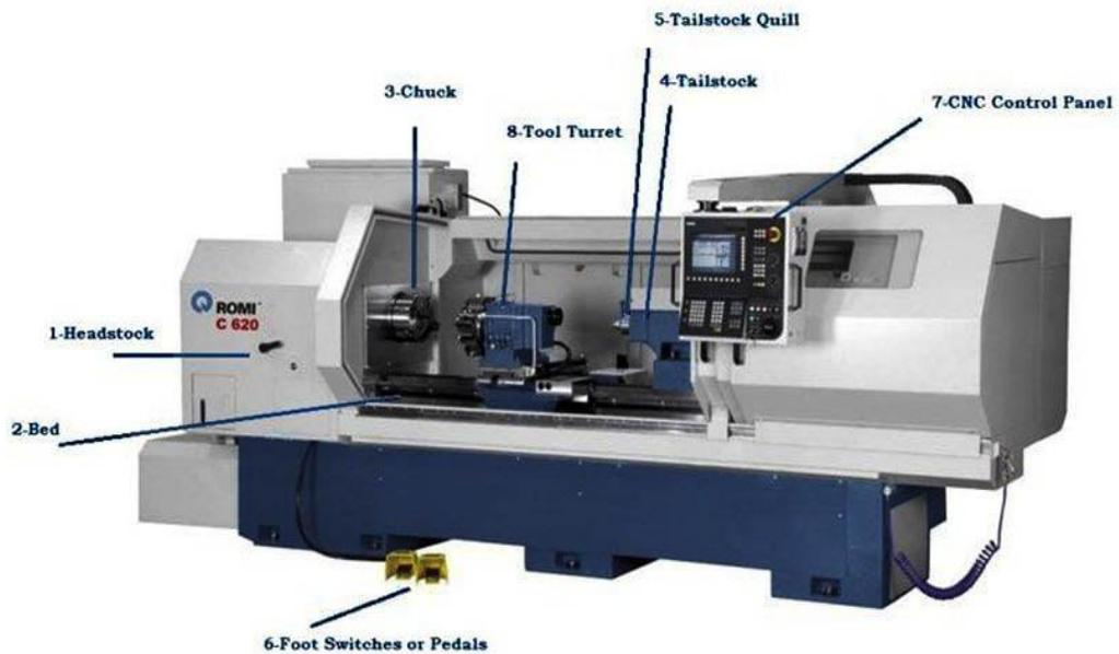
Gambar 2.3 Bagian-bagian Mesin Bubut *CNC*
