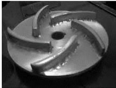
Gambar 2.2 Impeller Setengah Terbuka
