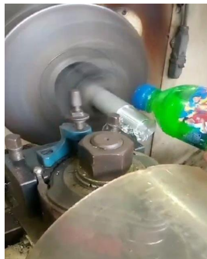
Lampiran 3. Proses pembubutan dengan pendingin Radiator Coolant
