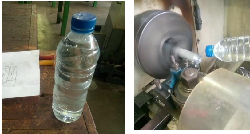
Lampiran 4. Proses Pembubutan dengan pendingin Air Sumur
