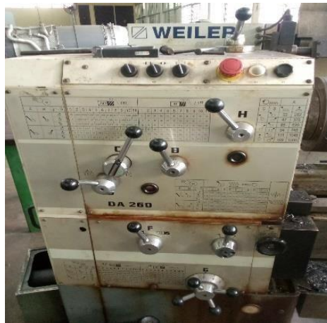
Lampiran 2. Mengatur kecepatan spindle
