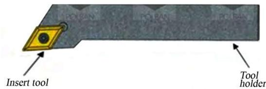
Gambar 2.17 Insert Tool dan Tool Holder
