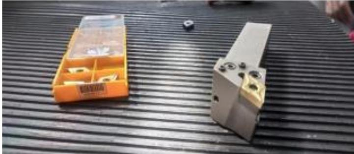
Gambar 2.3 Insert dan Holder Bubut CNC
