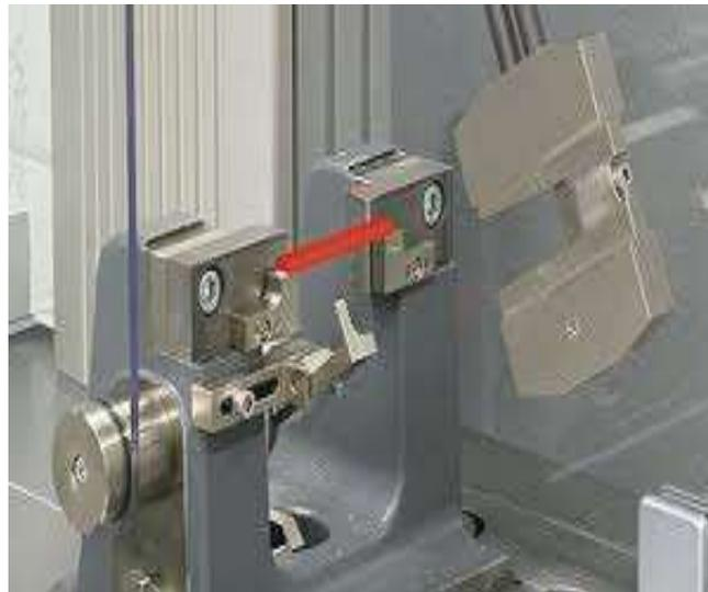
**Gambar 2.23** Pengujian impact
