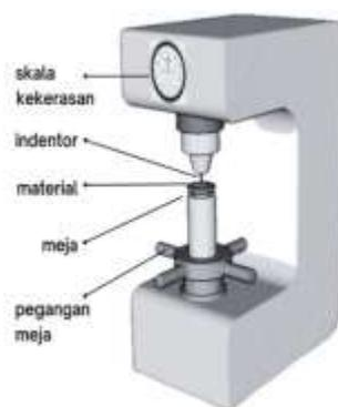
**Gambar 2.24** Pengujian Kekerasan
