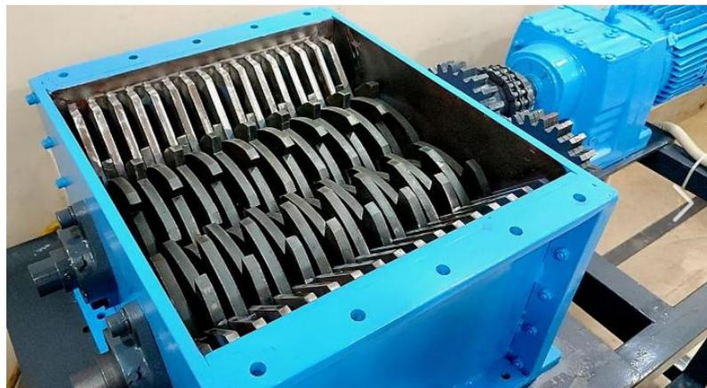
**Gambar 2. 6.** Mesin Pencacah Plastik *Shredder*
