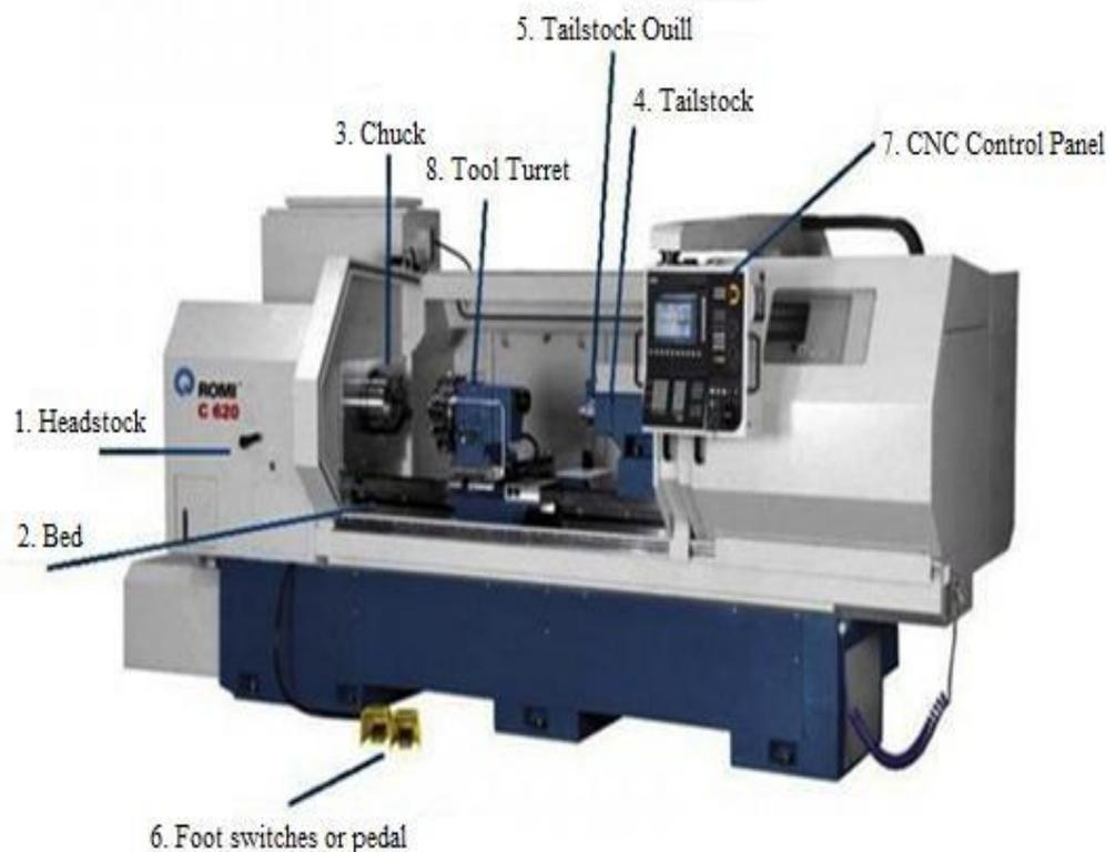
Gambar 2.2 Mesin Bubut CNC
