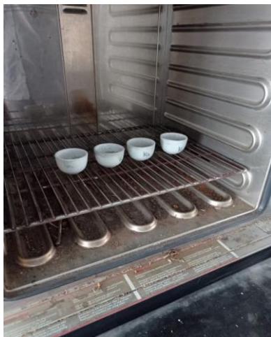
c. Tanah Yang Akan Dikering Ovenkan
