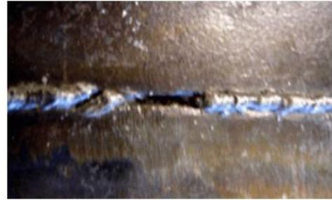
**Gambar 2.11** *Incomplete Root Penetration* atau *Lack Of Root Penetration*
