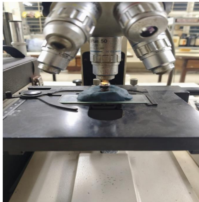
Lampiran 4. Pengamatan Struktur Mikro dengan Menggunakan Mikroskop Cahaya Analog
