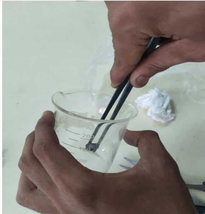
Lampiran 3. Pencelupan Bahan Uji ke Cairan Nitrit Acid Sebelum Penghalusan dengan Kertas Pasir
