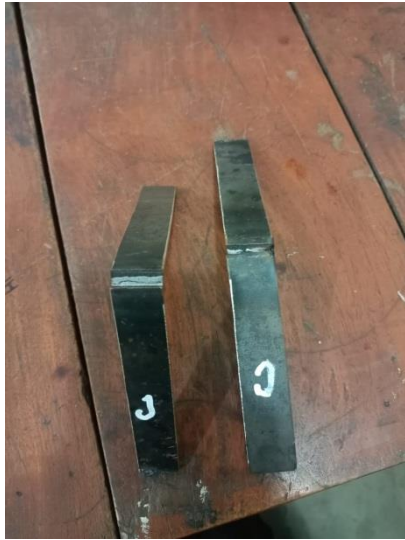
Foto Spesimen Kampuh las J Setelah Dilakukan Uji Bending
