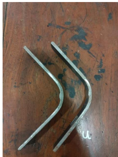
Foto Spesimen Kampuh Las U Setelah Di Uji Bending
