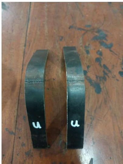
Foto Spesimen Kampuh Las U Setelah Di Uji Bending
