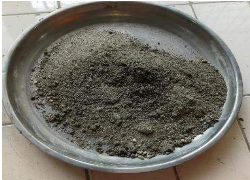
Gambar 2.4 : Agregat Halus ( Pasir ) Sumber : Laboratorium Jalan Raya UISU (2023)
