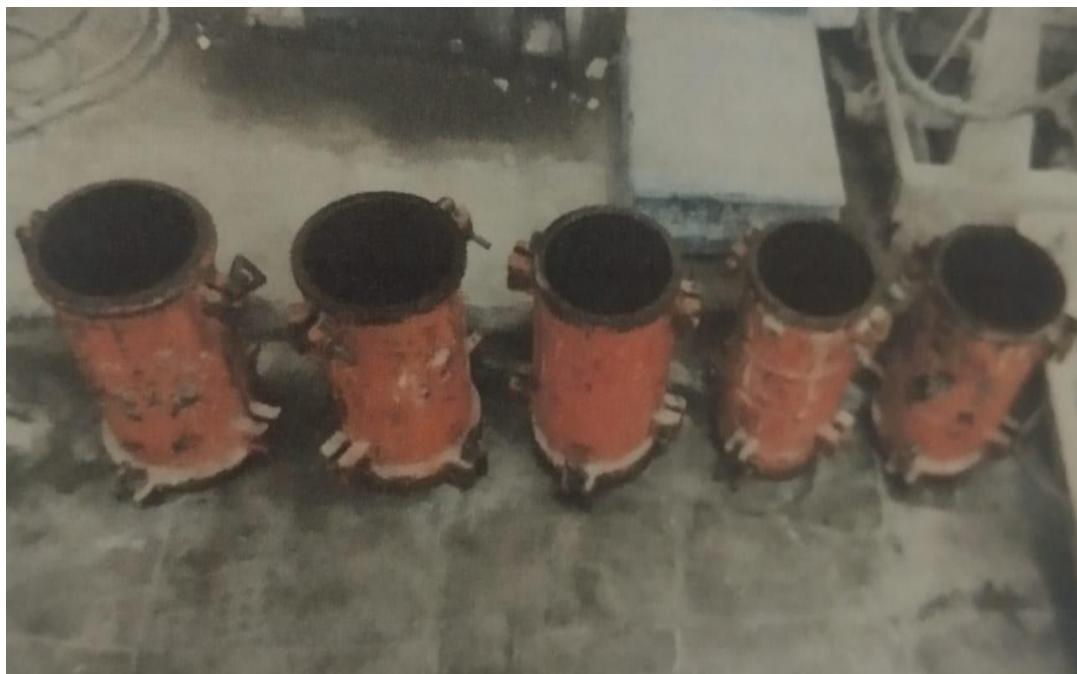
Beton Yang Baru Dimasukan Kedalam Cetakan Dan Beton Yang Sudah Dilepas Dari Cetakan
