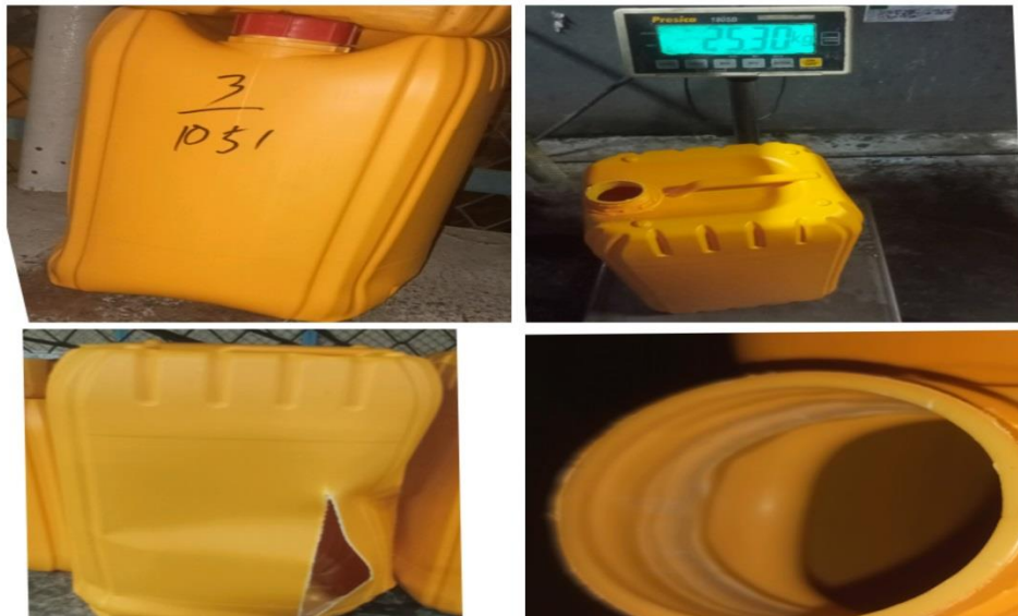
Gambar 1.1 Produk Cacat/ Reject
