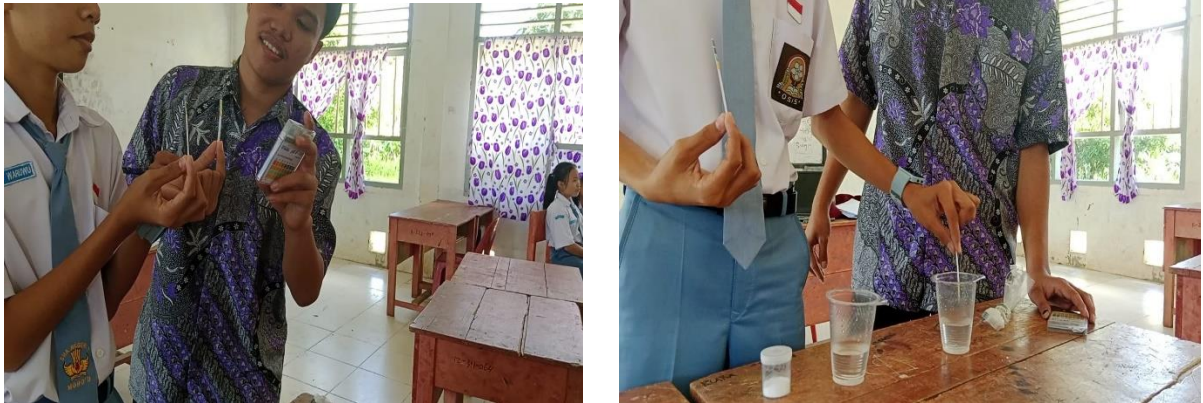
Gambar 6 Percobaan Uji pH Garam Terhidrolisis Menggunakan Indikator Universal
