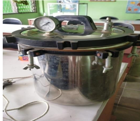
Gambar 4. Mesin autoclave yang berfungsi mensterilkan benda.
