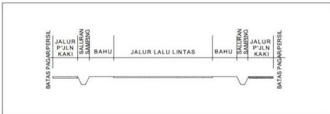
Gambar 2.1 Potongan Melintang Jalan Untuk Jalan Perkotaan
