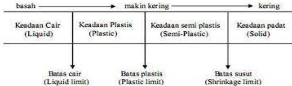
Gambar 2.1 Batas-Batas Konsistensi Tanah
