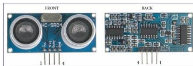
Gambar 2.10 Bentuk Sensor Ultrasonik HC-SR04
