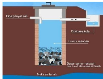
Gambar 2.12 Sumur Resapan
