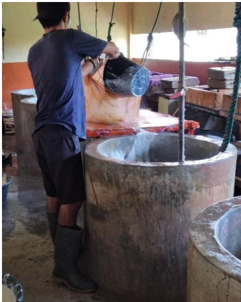
Proses Penyaringan dan Pematatan filtrat tahu
