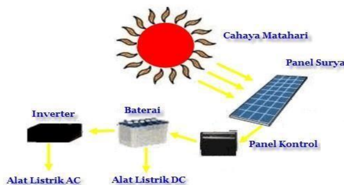
Gambar 2.10. Prinsip Kerja Sel Surya
