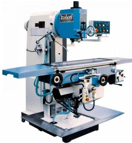
Gambar 2. 8 Mesin Frais Tipe Khusus (*Special Purposes*). Mesin Frais Dengan Dua Buah Spindel
